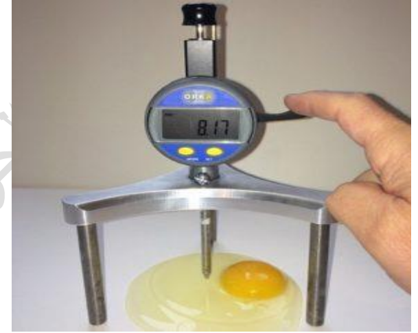
شكل (1) المايكروميتر الخاص بقياس ارتفاع البياض
