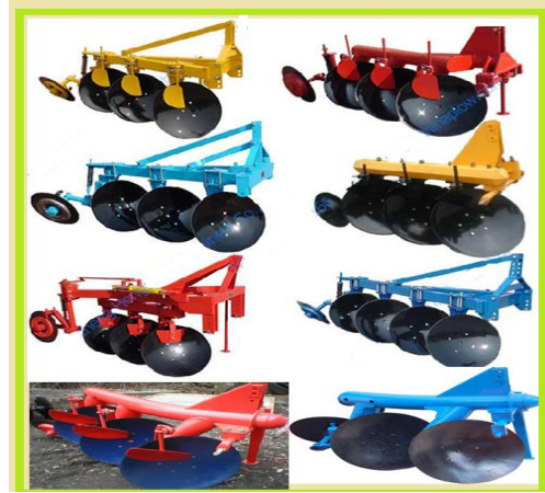
شكل (3-10) أنواع الهيكل لمحارث قرصية مختلفة
