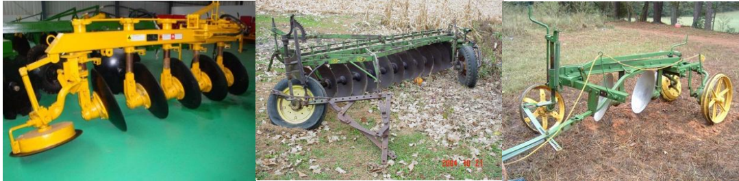
شكل (3-5) أنواع مختلفة من المحراث القرصي المسحوب (مقطور)
