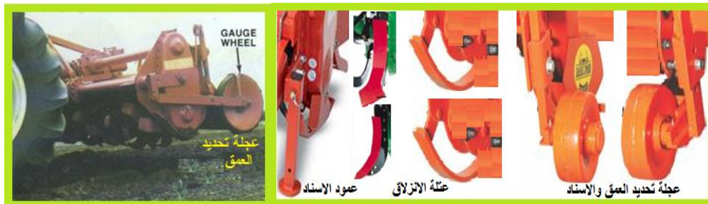
شكل (5-11) عجلة تحديد العمق أو الانزلاق وعجلتي الإسناد للمحراث المسحوب وعمود الإسناد
