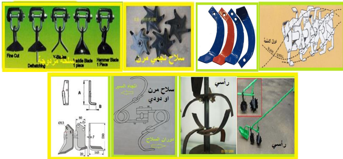
شكل (5-10) أشكال مختلفة أخرى من أسلحة المحراث الدوراني ودوران الأسلحة اللولبي
