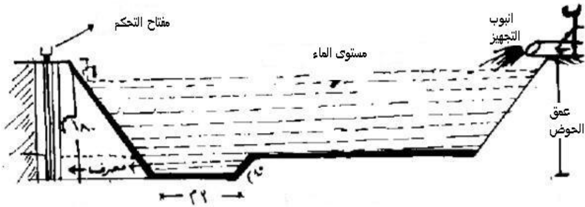
شكل (1) يوضح تصريف الماء باستخدام طريقة مفتاح التحكم.
