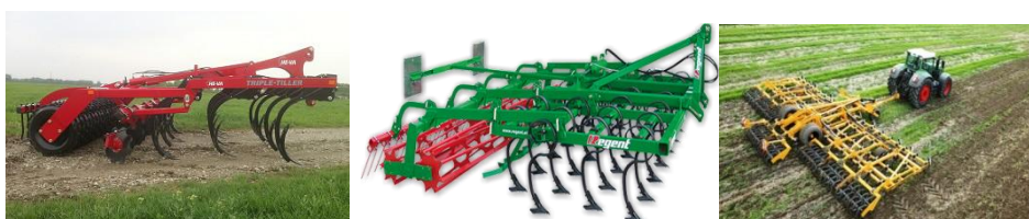
شكل (4-17) ربط المحراث الحفار بلامشاط القرصية والمهارس
