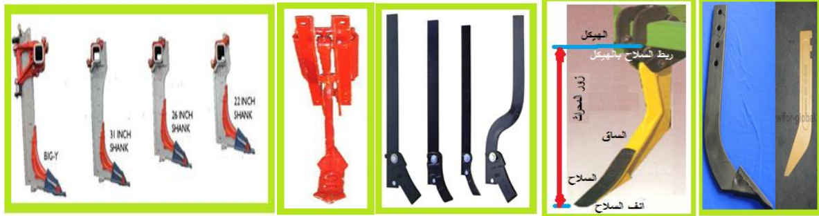
شكل(4-11) زور المحراث وبعض أنواع من السيقان الصلبة
