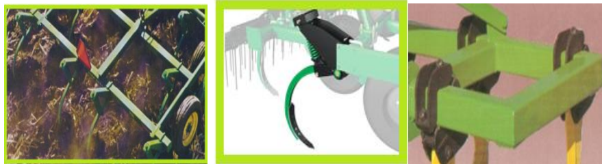
شكل ( 4-13) ربط الساق بالهيكل
