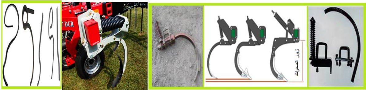
شكل (4-12) أنواع وأشكال مختلفة للساق المرنة
