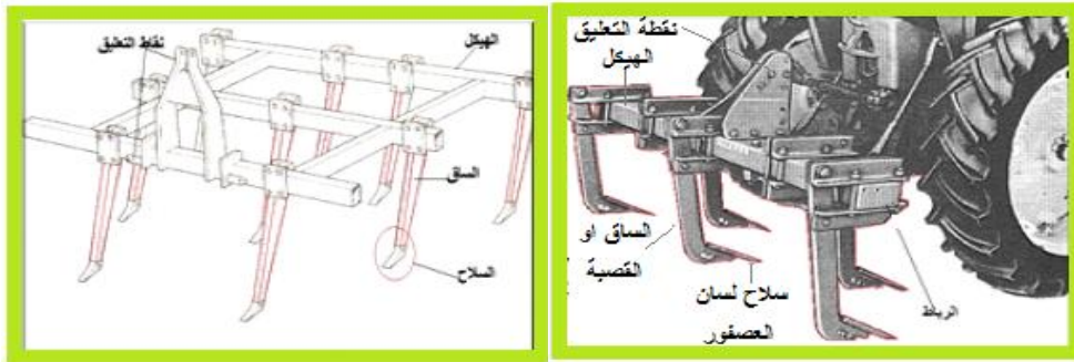
شكل (4-8) : مخطط وصورة للمحراث الحفار وأجزائه
